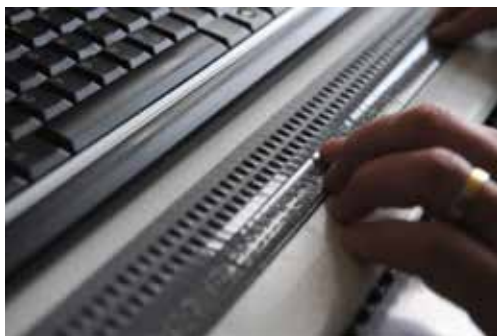
Slika 30: Brajeva vrstica za računalnik
