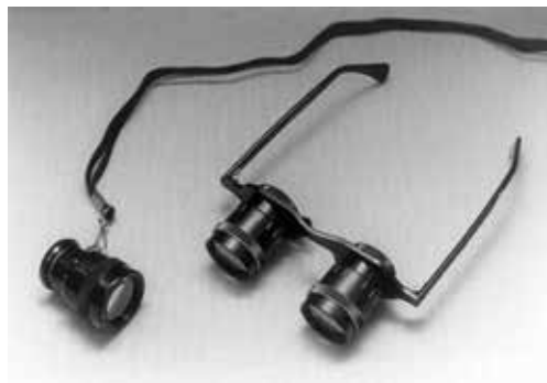
Slika 19: Galilejev teleskop, lahko montiran na očala
