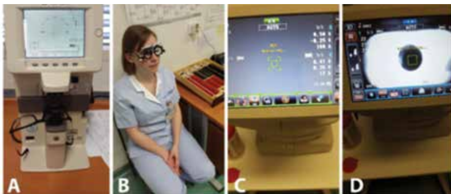
Slika 2: Preiskave vidne ostrine in očesnega pritiska. A – lensmeter; B – preverjanje vidne ostrine s Snellenovimi in Jägerjevimi tabelami; C – refraktometer; D – nekontaktni tonometer.
